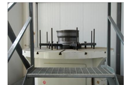
CORNERING FATIGUE TEST (BENDING)
